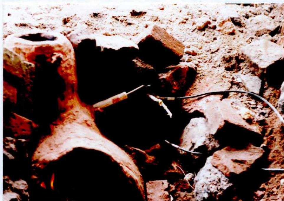
Obr. 30: J6/7: Umístění termočlánků.
