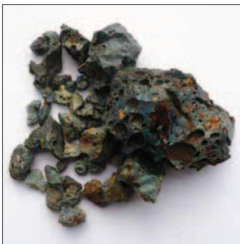
Obr. 4. Zbytky nepovedené kobaltové skloviny z Hamerského údolí v Broumově. (foto Jiří Hlávka)
