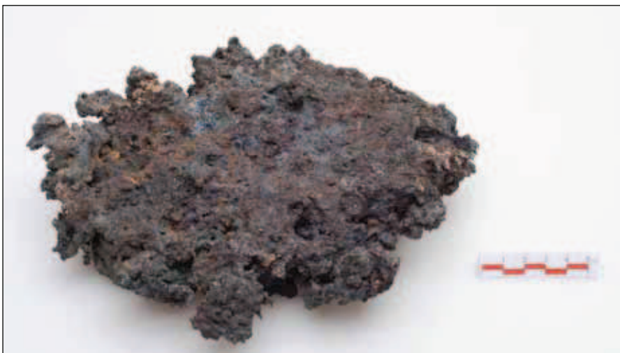
Obr. 14. J-09-06 Železná houba po prvotním zpracování. (foto Eva Řezáčová)
