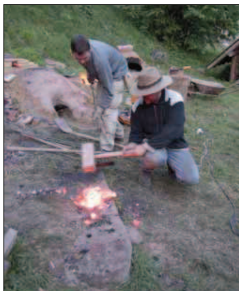
Obr. 7. J-09-02 Prvotní zpracování železa dřevěnou palicí ihned po vylomení z pece. (foto Jiří Merta)
