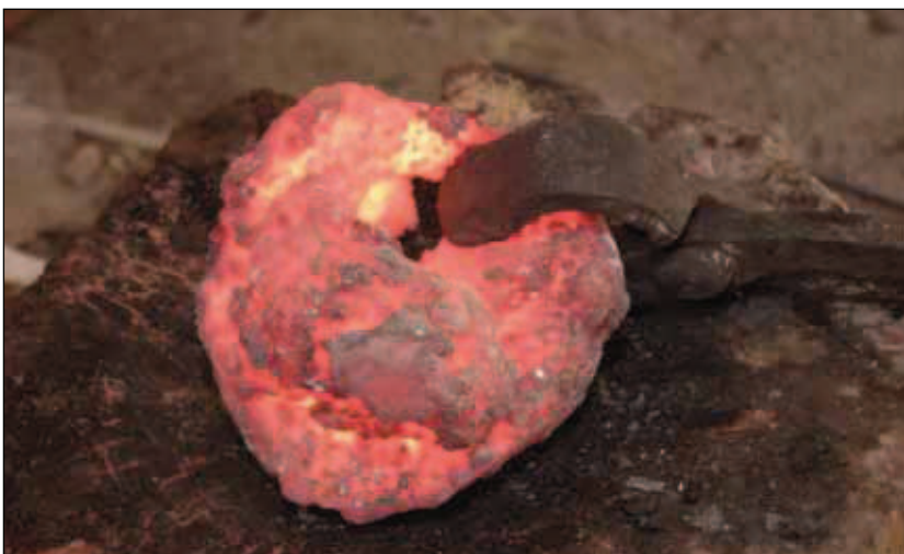
Obr. 16. Kování fáze 1: polotovár na dřevěném špalku – separace strusky a vytvoření kompaktního tvaru železa. (foto Martin Barák)
