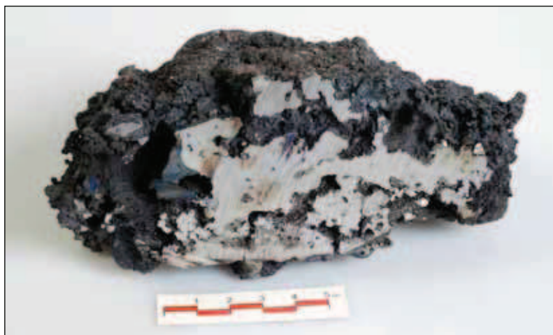
Obr. 13. J-09-05 Polovina železné houby. Z řezu je patrné, že se při prvotním zpracování houby po vytažení z pece podařilo oddělit železnou houbu od většiny strusky. (foto Eva Řezáčová)
