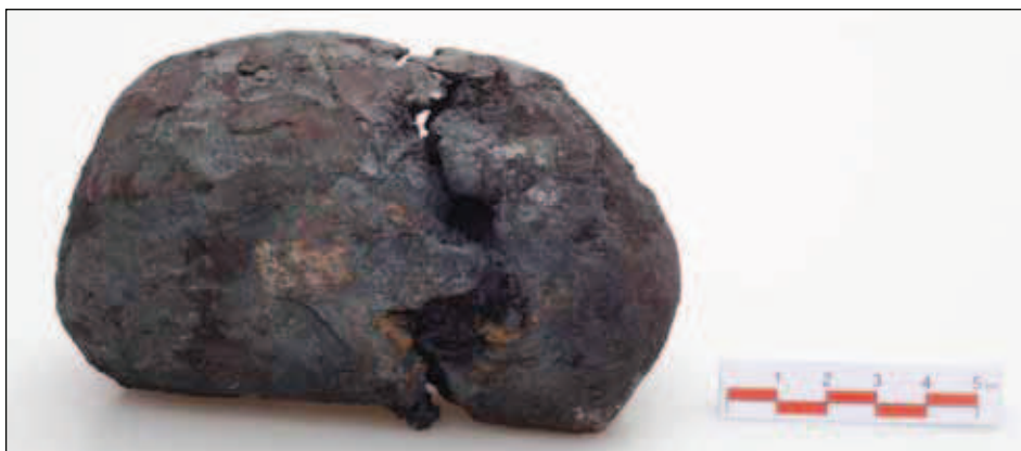
Obr. 18. Bochníkovitý polotovár JK-09-02 „zezadu“. Je vidět oddělení obou částí v místě záseku. (foto Eva Řezáčová)
