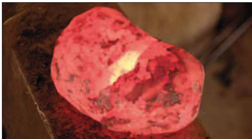
Obr. 17. Bochníkovitý polotovár JK-09-02 se zásekem na kovadlině. Díky nedokonalému prokování se bochník v místě záseku nakonec rozpadl. (foto Martin Barák)
