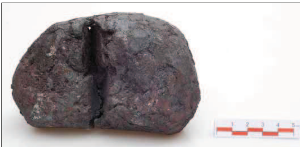
Obr. 10. Zpracovaný produkt tavby J-09-03 – bochníkovitý polotovár (JK-9-02). (foto Eva Řezáčová)
