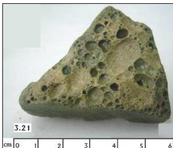
Obr. 3 Pórovitý zelený kúsok trosky
