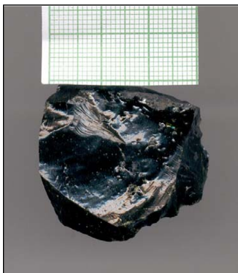
Obr. 1 Nitra, sklovitá forma železiarskej strusky z pozostatkov pecí z 9. storočí
