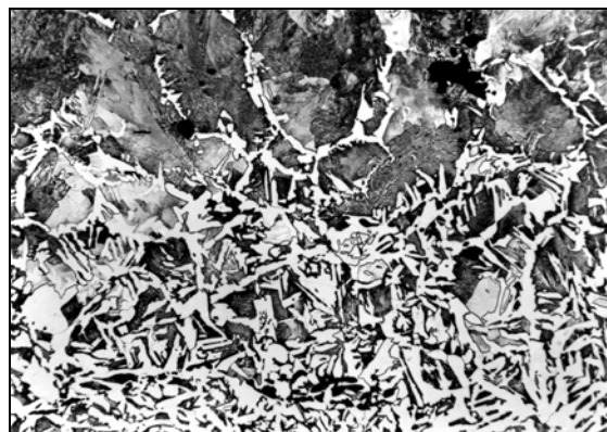
Obr. 3 Mikrostruktura kovářsky zpracované železné houby v oblasti s nízkým obsahem uhlíku. Leptáno nitaem, zvětšeno 100x
