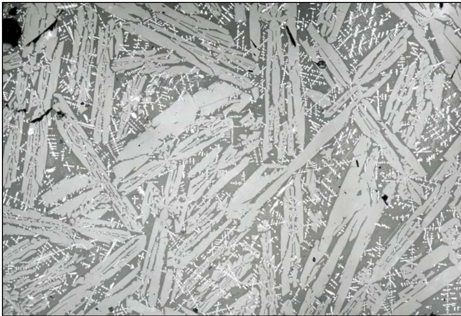
Obr. 3 Starý hamr v Josefském údolí. Mineralogická struktura strusky (1) podle tab. I je tvořena rozměrnými krystaly fayalitu a skelnou hmotou s druhotně vyloučenými kostrovitými útvary wüstitu. Neleptáno, zvětšeno 200x
