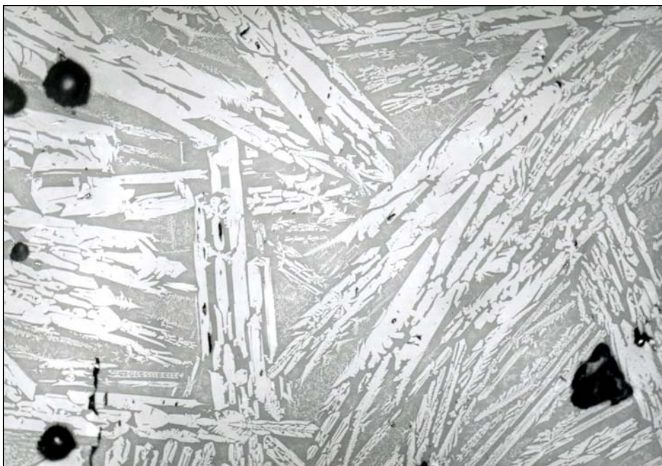
Obr. 4 Starý hamr v Josefském údolí. Mineralogická struktura strusky (2) podle tab. I je tvořena rozměrnými krystaly fayalitu a skelnou hmotou. Wüstit se ve struktuře této strusky nenachází. Neleptáno, zvětšeno 200x
