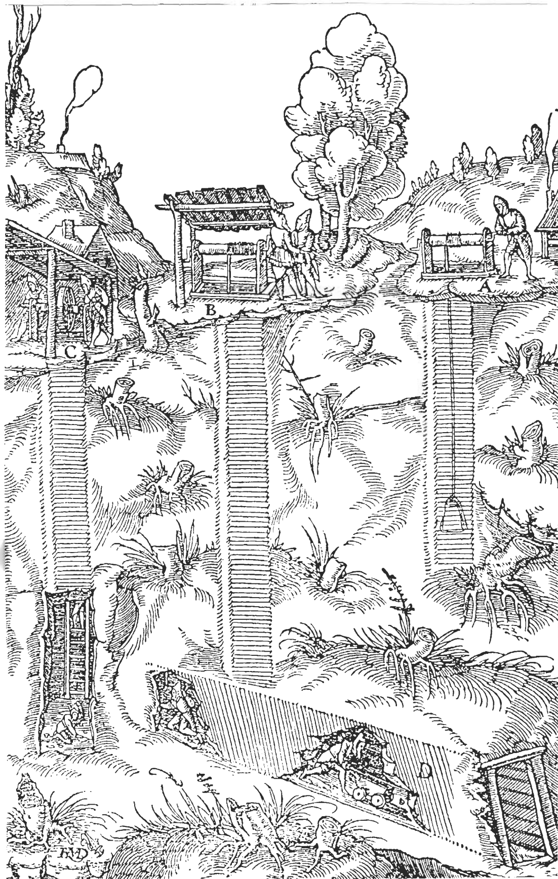
Obr. 1 Vyobrazení podoby středověkého dolu podle Agricoly z roku 1556: A - šachta, B, C - překop, D - druhá šachta, E - štola, F - ústí štoly
