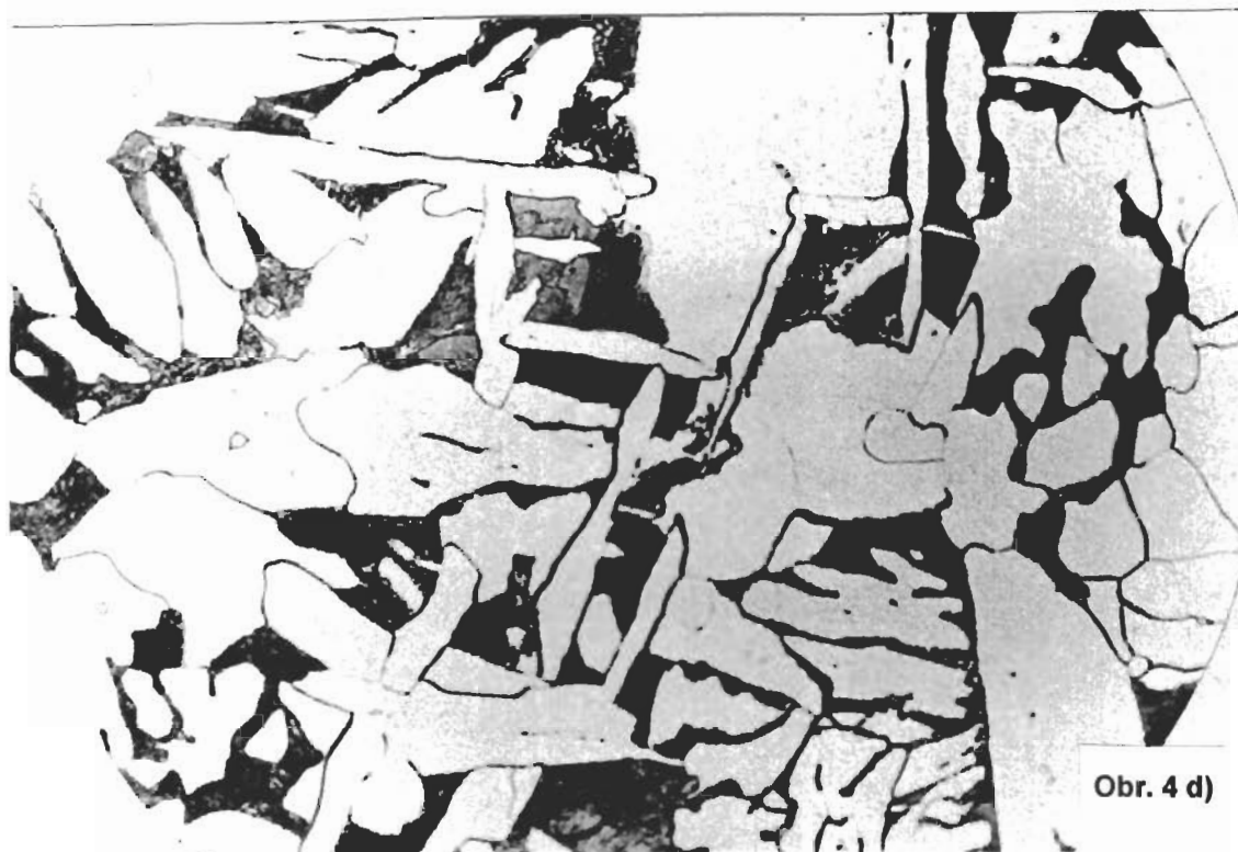
Obr. 4. a) Perlitická struktura se síťovým feritu po hranicích původních austenitických zrn (vzorek č. 4, leptáno Nital, zvětšeno 200x), b) Feritická struktura s polyedrickými zrny s precipitáty uvnitř zrn (vzorek č. 16, Nital, 200x), c) Feriticko perlitická oblast se zbytky Widmannstattenovy struktury (vzorek č. 22, Nital, 200x ), d) Feriticko perlitická struktura ve vzorku č. 3 se zvýšeným obsahem fosforu a se zbytky nerozpuštěného fosfidického eutektika (Nital , 200 x).
