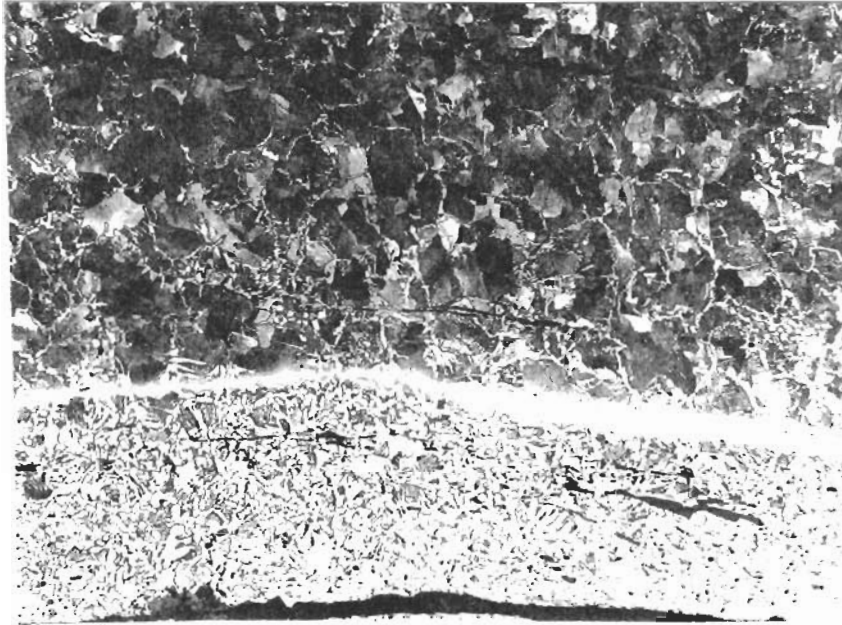
Obr. 3 Svařené dva různé materiály v tuleji dláta – ocel 0.6 %C a železo 0.2%C
