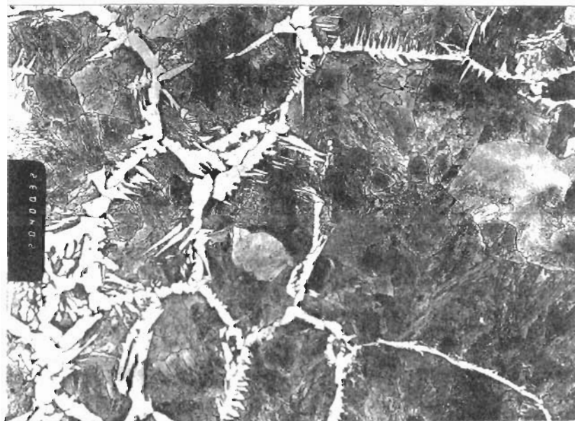
Obr. 6 Ocel 0.3%C v tuleji dláta, nárůst zrna při ohřevu pro cementaci
